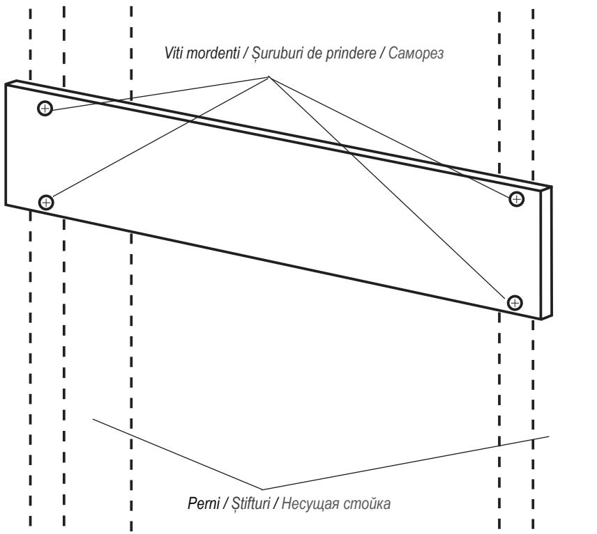
! Nota: Se desideri appendere le due bande del pannello forato una accanto all'altra, utilizza un asse da 1" x 4" x 37" ( $\approx 2,54 \text{ cm} \times 10,2 \text{ cm} \times 94 \text{ cm}$ ) e fissa l'asse su tre perni usando sei (6) viti mordenti da 2" (due per ogni perno).
